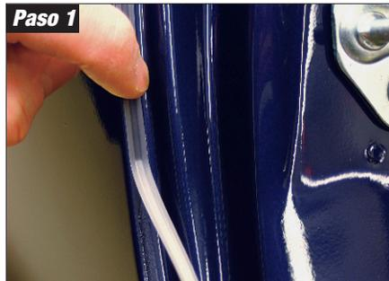
Aplique la primera tira, siguiendo y alineando la línea de la carrocería exterior del marco con el borde externo de la cinta.
